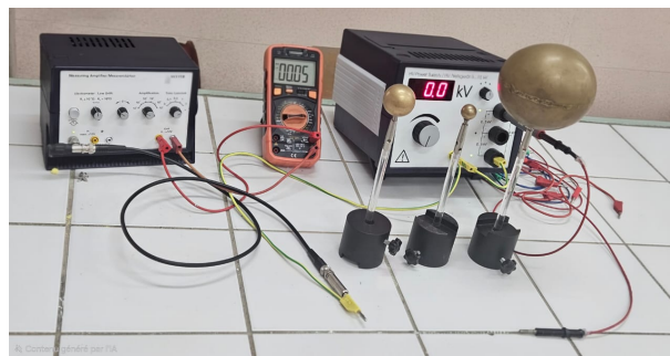
FIGURE 13 – dispositif expérimental utilisé pour déterminer la capacité d'un condensateur sphérique
